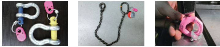
他社製品へのIDタグ導入例 スリング、シャックル等
