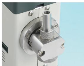
吸引口のインパクターで粗大粒子をカットし、浮遊粒子のみを測定します。4μm50%カット、10μm98%カットを選択できます。
