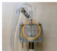
測定終了後、カセットハウジングを分析会社へ送り、マンガン測定を依頼する。
