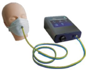
本体とマスクにチューブが挿さっていることを確認したら、被験者はマスクを装着し、5分程待機します。(ゼロフィルターは外します。)
