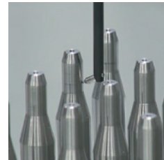
テーブルをX/Y方向に移動することで、段取り替えすることなく複数のワーク（箇所）を測定
