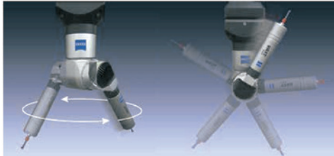
東京精密 三次元座標測定機 AXCEL RDS ブルーヘッド位置決め数 5,184通り
