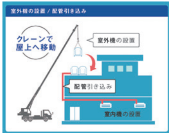
室外機・室内機の設置施工、倉庫内の空調環境を改善
