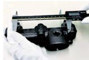
ノギスでねじ穴ピッチを測定
