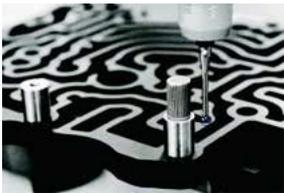
三次元測定機でねじ穴位置を測定
