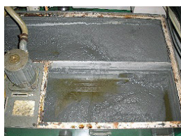
<角型クーラントタンク> タンク内のスラッジ堆積により、クーラント液から悪臭発生。清掃回数は増加。
