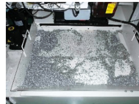
タンク上部の網で切りくずを溜め、網を通過した切りくずはタンク底に堆積
