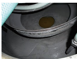
<渦流型クーラントタンク> タンク内のスラッジ堆積を抑え、クーラント液の腐敗を遅延。清掃回数は軽減。
