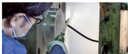
高温・高圧のスチームは水滴が残らずサビないので、高性能の製品の洗浄に使用できます。予防洗浄による製品の品質維持や生産効率の向上。メンテナンスの回数も削減できます。
