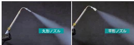
金型の種類や形状に合わせて、ノズルの先端を選べます。
