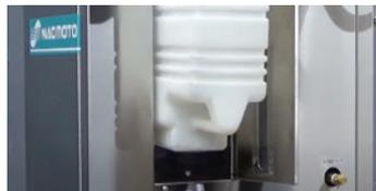
給水はタンク式または水道直結式。機械缶体内の水は自動給水します。
